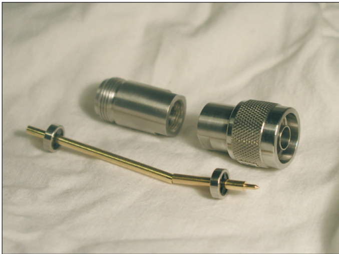
Liittimien lisäksi RF-kytkennöissä tarvitaan monenlaisia sovitimia. Kuvassa N-liittimistä koostuva pistoke-pistokkasovitin purettuna.
